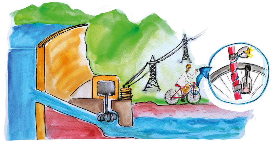
Producción de corriente eléctrica mediante una dinamo, en una bicicleta y en una central hidroeléctrica.
